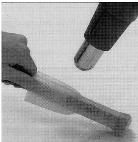
Votre grossisseur devra être posé à froid sur le manche en couvrant également le bouchon. Etant donné qu'il est rétractable, il serait même préférable de le faire dépasser d'environ 2 mm.
